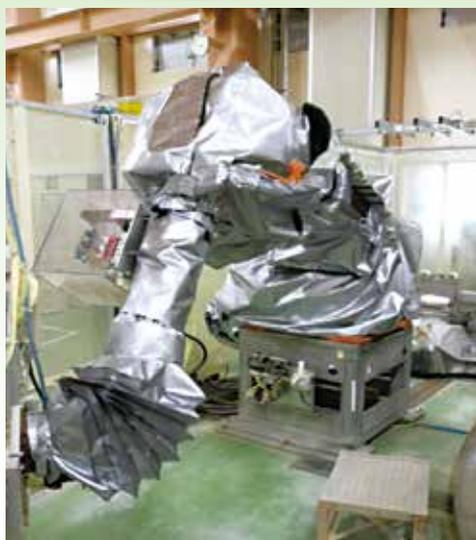
産業用ロボットは、苛酷な条件の下で稼働しています。危険な場所など、あらゆる悪い条件の下で人間に代わって働いています。ロボットプロテクターをロボットに装着することで、故障の原因をなくし、ロボットの寿命が長くなり、メンテナンス性が向上します。
